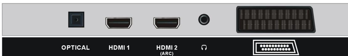
Utilisez un câble OPTIQUE pour connecter le téléviseur à un amplificateur audio ou à un autre appareil de décodage audio pour sortie audio.
