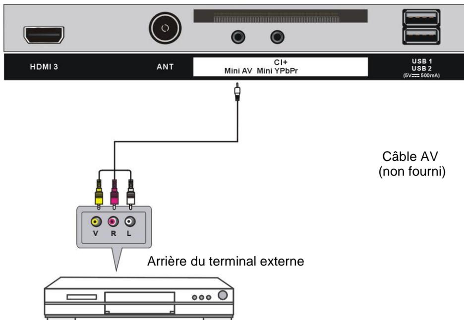
**REMARQUE :** lors de la connexion d'un appareil externe, faites correspondre la couleur de la borne à celle du câble.
