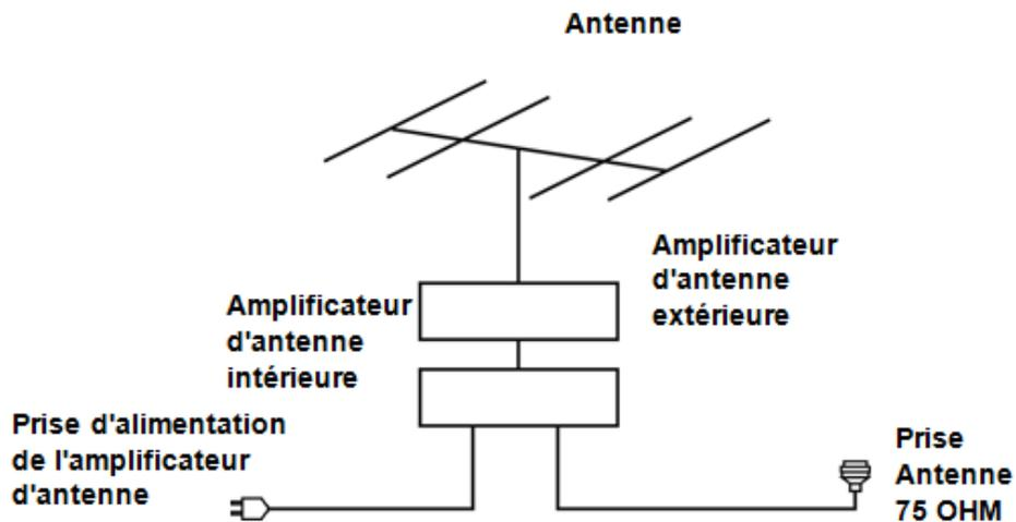
Branchez une antenne dans le terminal d'antenne pour obtenir la meilleure qualité d'image possible. L'utilisation d'amplificateurs d'antenne est optionnelle ou dépend du type d'antenne extérieure utilisée.
